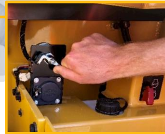
Manuaaliohjauksen ja etäohjauksen valintakytkin
